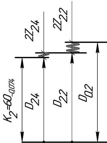
**Рисунок 4.5 – Размерная схема диаметра  $\varnothing 60_{-0,074}$**
