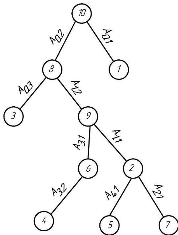
**Рисунок 4.7 – Граф технологических размеров ТП механической обработки вала (осевое направление)**
