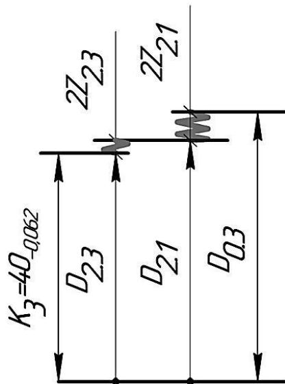
**Рисунок 4.4 – Размерная схема диаметра  $\phi 40_{-0,062}$**
