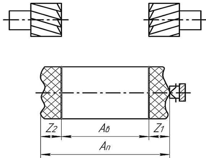
**Рисунок 2.3 – Схема двустороннего фрезерования торцов (припуск  $Z_2$  – замыкающее звено, припуск  $Z_1$ , размеры  $A_B$  и  $A_n$  – составляющие звенья)**
