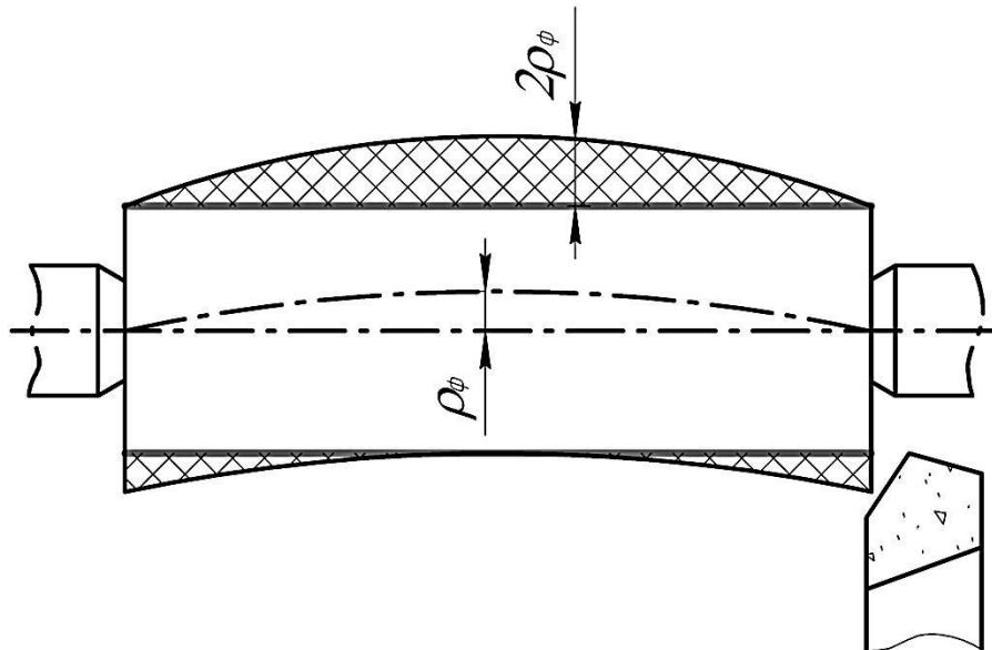
**Рисунок 3.6 – Влияние изогнутости оси заготовки на величину припуска при точении**
