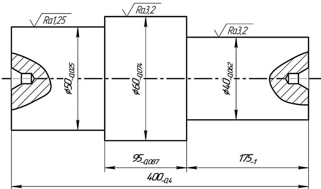
Рисунок 4.1 – Эскиз вала для проведения размерного анализа проектируемого ТП
