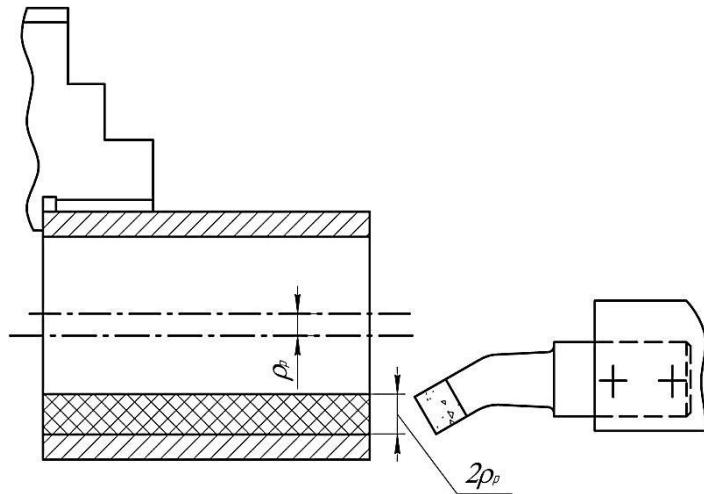
**Рисунок 3.9 - Влияние погрешности взаимного расположения обрабатываемой поверхности и технологической базы на величину припуска при растачивании отверстия**
