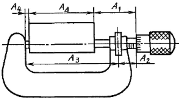
**Рисунок 1.3 – Измерительная размерная цепь, возникающая при измерении линейного размера детали**
