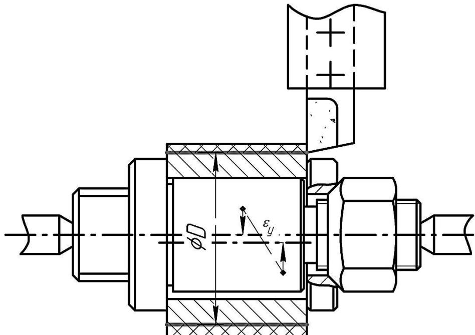
**Рисунок 3.5 – Схема точения наружной поверхности втулки на оправке с зазором**
