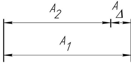
**Рисунок 1.4 – Трехзвенная размерная цепь**
