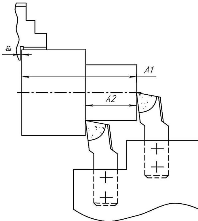
**Рисунок 3.1 – Схема одновременной подрезки двух торцов на токарно-револьверном станке**
