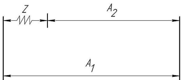
**Рисунок 3.14 – Типовая технологическая размерная цепь с замыкающим звеном - припуском**
