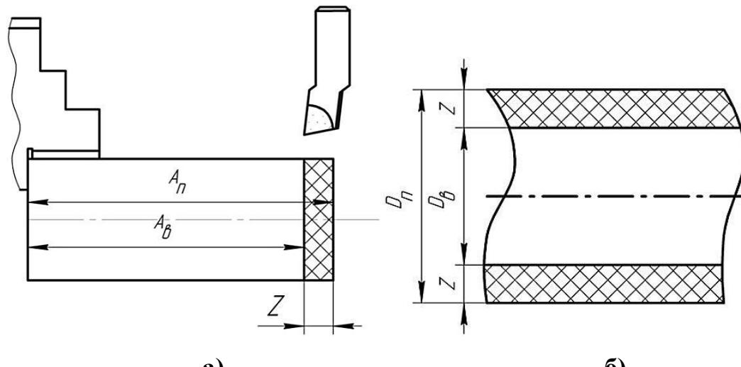
**Рисунок 2.1 – Технологические размерные цепи с замыкающим звеном припуском (размеры  $A_{\text{в}}$  и  $A_{\text{п}}$  – составляющие звенья; припуск  $Z$  – замыкающее звено – а; размеры  $D_{\text{в}}$  и  $D_{\text{п}}$  – составляющие звенья; припуск  $Z$  – замыкающее звено – б)**
