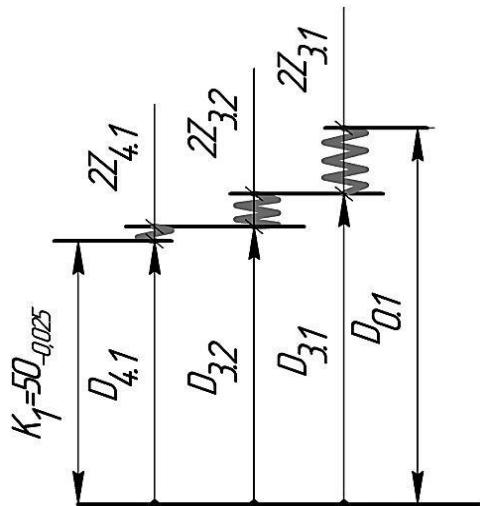
**Рисунок 4.3 – Размерная схема диаметра  $\phi 50_{-0,025}$**
