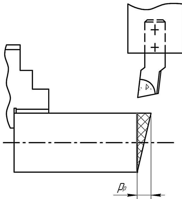
**Рисунок 3.10 – Влияние погрешности взаимного расположения обрабатываемой поверхности и технологической базы на величину припуска при подрезании торца**
