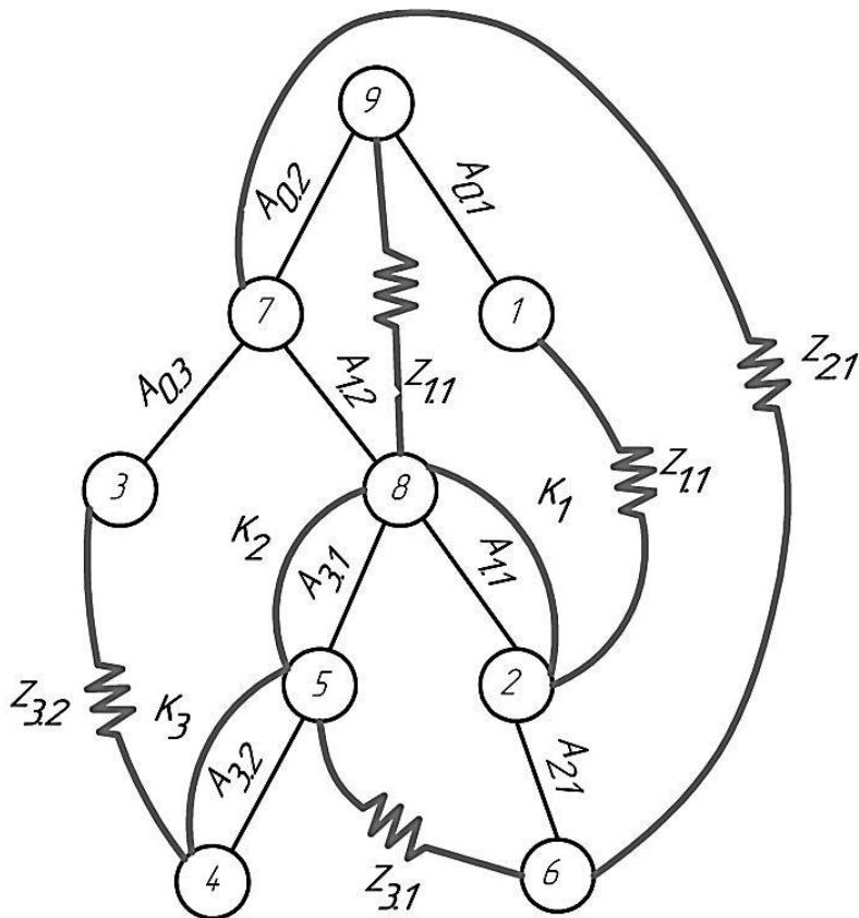
**Рисунок 4.12 – Скорректированный граф размерных связей ТП механической обработки вала (осевое направление)**
