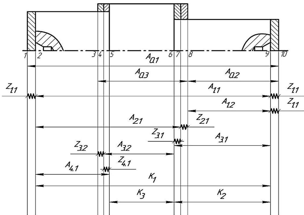
**Рисунок 4.6 – Размерная схема ТП механической обработки вала (осевое направление)**
