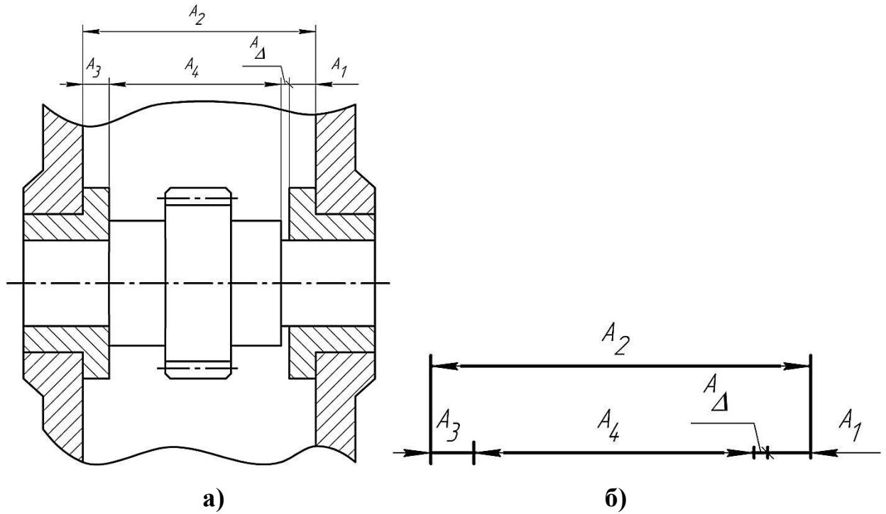
**Рисунок 1.1 – Конструкторская размерная цепь редуктора, обеспечивающая зазор между торцом вала-шестерни и торцом втулки а), схема размерной цепи б) (1 – корпус; 2 – втулка; 3 – вал-шестерня; 4 – втулка)**
