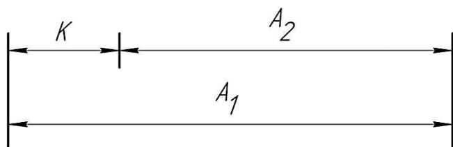
**Рисунок 3.15 - Типовая технологическая размерная цепь с замыкающим звеном – конструкторским размером**
