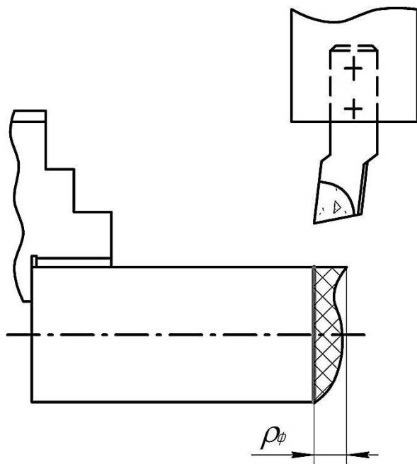
**Рисунок 3.7 – Влияние погрешности формы торца заготовки на величину припуска при подрезании торца**
