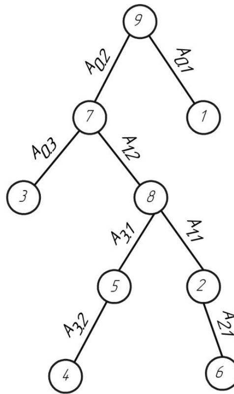
**Рисунок 4.11 –Скорректированный граф технологических размеров ТП механической обработки вала (осевое направление)**
