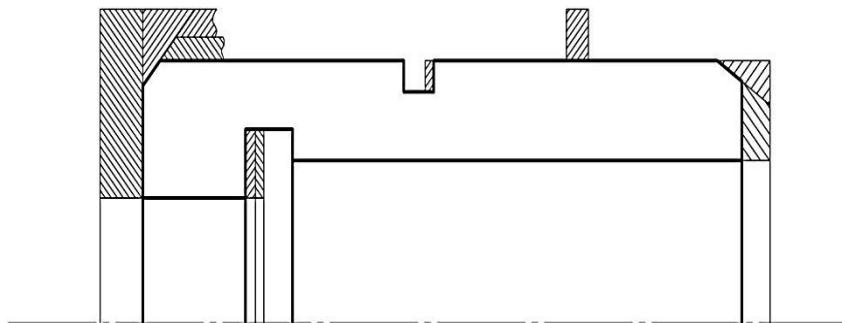
**Рисунок 2.6 – Эскиз детали «стакан» с нанесенными припусками**
