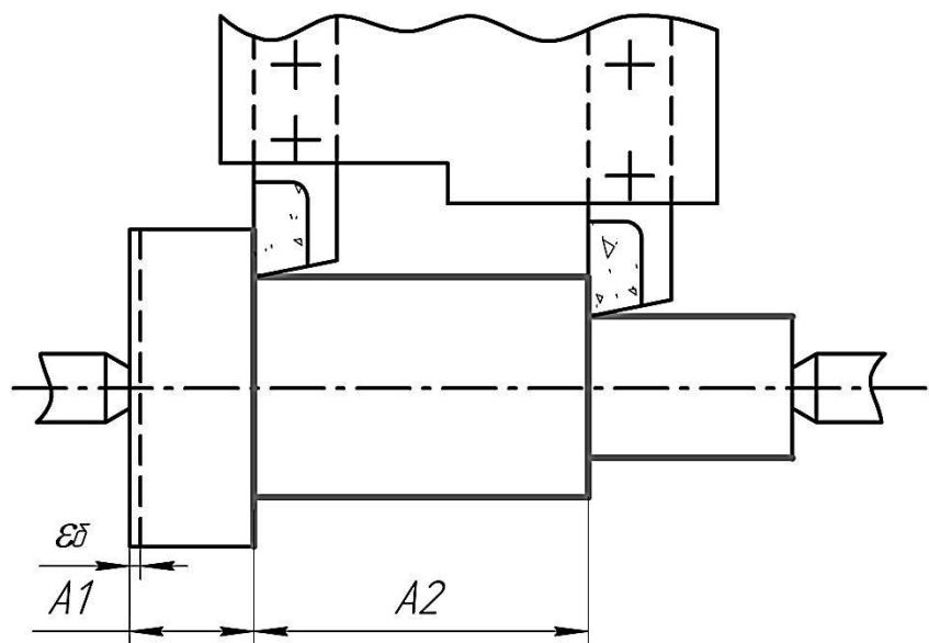
**Рисунок 3.4 – Схема точения заготовки в центрах**
