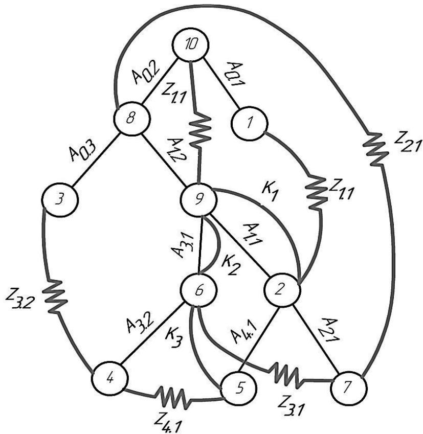
**Рисунок 4.8 – Граф размерных связей ТП механической обработки вала
