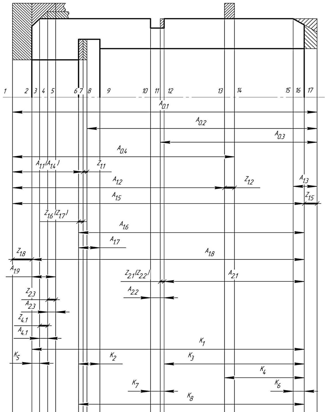
**Рисунок 2.7 – Размерная схема технологического процесса изготовления
