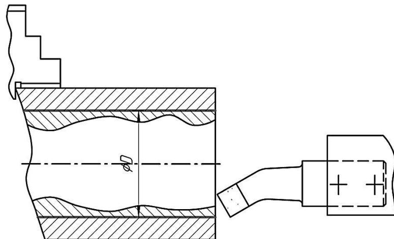
**Рисунок 3.3 – Схема растачивания отверстия**
