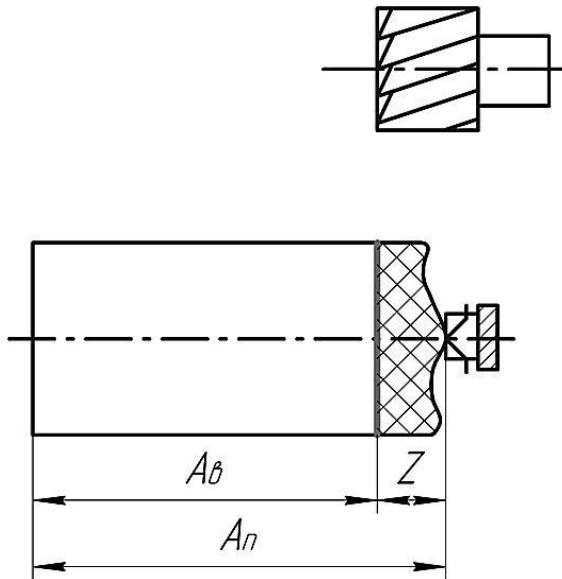
**Рисунок 2.2 – Технологическая размерная цепь с припуском - составляющим звеном**
