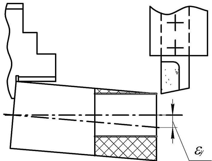
**Рисунок 3.11 - Влияние погрешности установки заготовки на величину припуска при точении**
