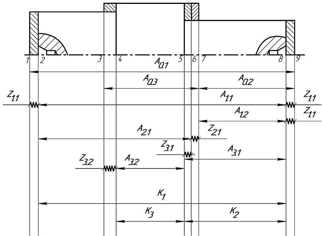
**Рисунок 4.10 – Скорректированная размерная схема ТП механической обработки вала (осевое направление) после замены торецкруглошлифовальной операции на круглошлифовальную**
