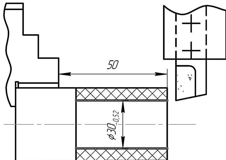
**Рисунок 3.13 – Расчетная схема для определения минимального припуска при точении**
