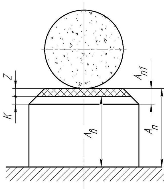
**Рисунок 2.4 - Схема шлифования торца с замыкающим звеном конструкторским размером**
