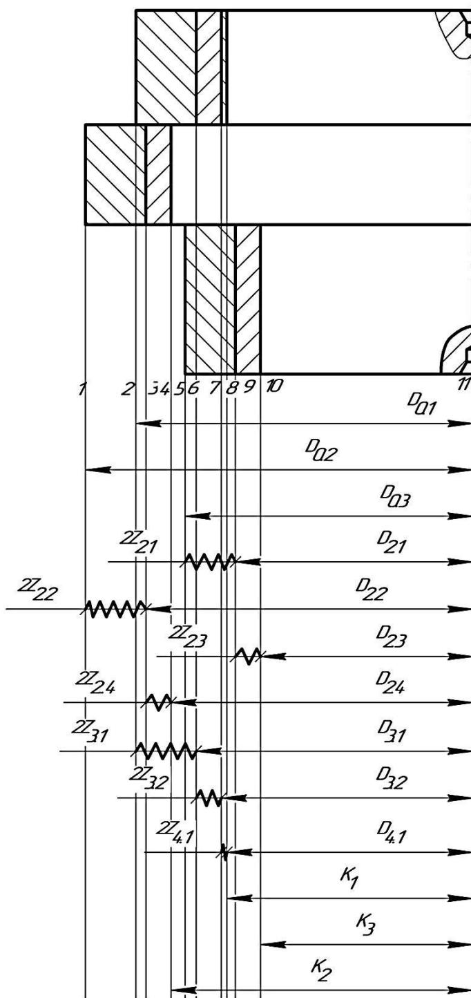
**Рисунок 4.2 – Размерная схема ТП механической обработки вала (радиальное направление)**
