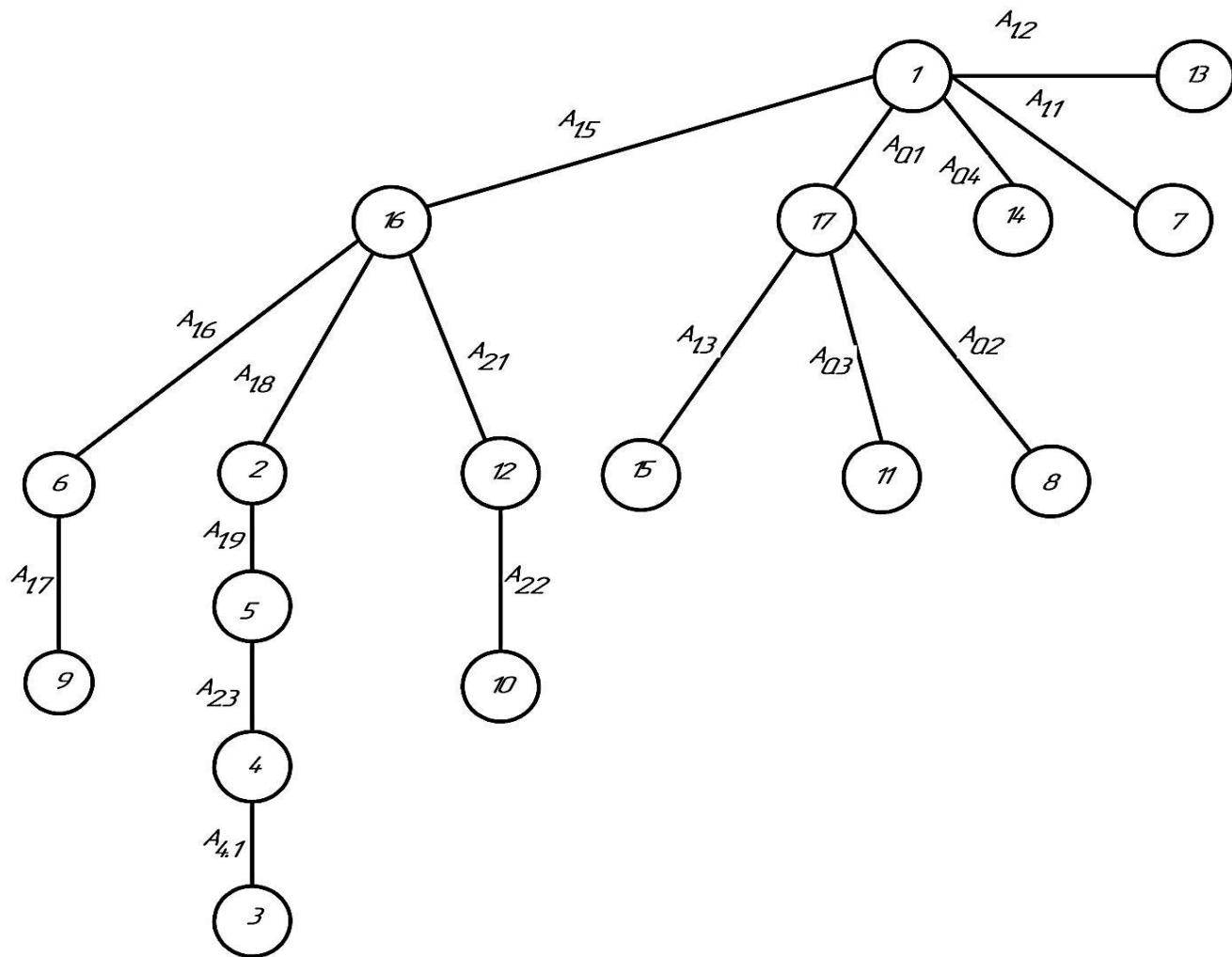
Рисунок 2.8 – Граф технологических размеров ТП изготовления детали «стакан»
