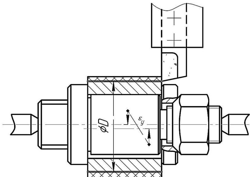
**Рисунок 3.12 – Влияние погрешности установки на величину припуска при точении**
