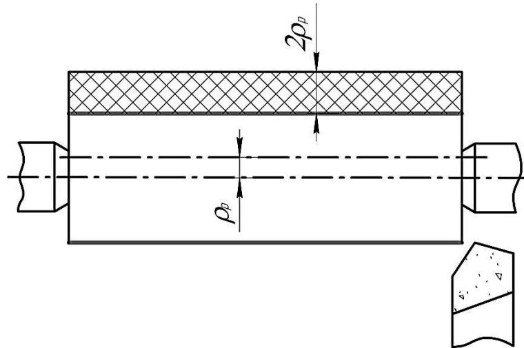
**Рисунок 3.8 – Влияние погрешности взаимного расположения обрабатываемой поверхности и технологической базы на величину припуска при точении**
