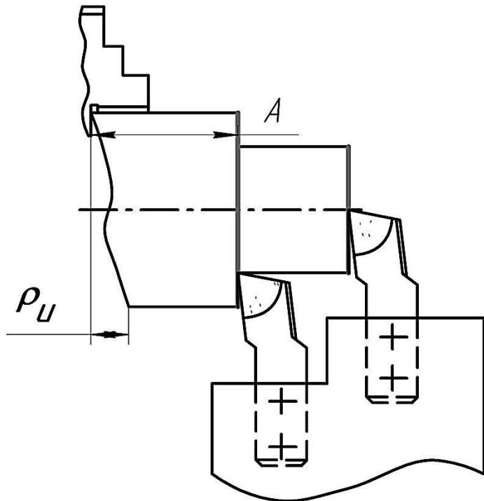
**Рисунок 3.2 - Схема подрезки торцев**
