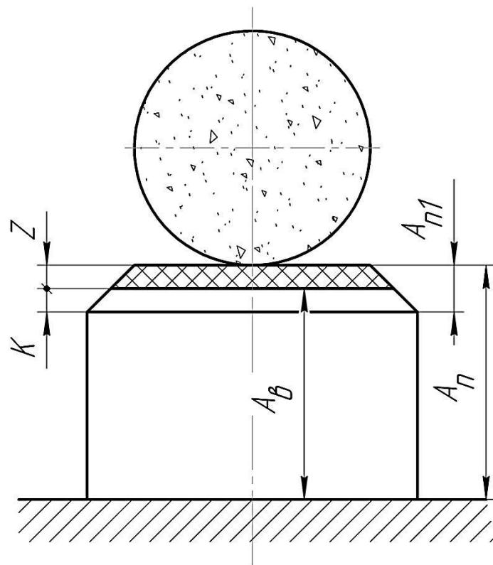
**Рисунок 1.2 – Технологические размерные цепи, возникающие при обеспечении размера фаски**
